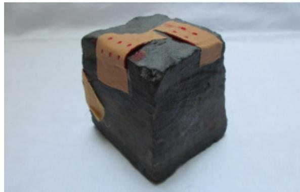
Abb. 7: „Rückseite“ des Pflastersteins nach der Restaurierung mit den beiden neuen Pflastern oben. Aufgenommen am 13.08.2024.
